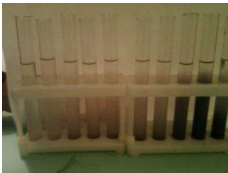
Рис. 15. Определение наличия крахмала в колбасном фарше
